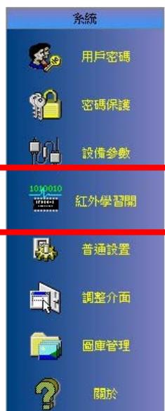
中控開啟系統 —》選擇紅外學習開 —》系統燈慢閃 —》按投影機開機鍵 —》系統燈快閃 —》按一下投影機遙控器的開機鍵 —》系統燈停止閃 —》過一秒繼續快閃 —》再次按一下投影機遙控器開機鍵 —》如果還是快閃則要繼續按遙控器 —》系統燈為慢閃則學碼成功 —》按投影機關機鍵 —》步驟同上直到投影機控制的鍵學完，在系統燈為慢閃的情況下 —》選擇紅外學習關 —》即可退出學碼狀態。
